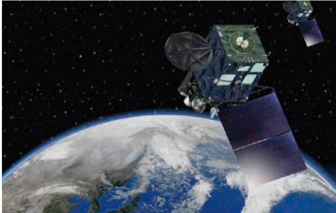
赤道上空約35,800Kmで 大気の状態を観測（気象衛星ひまわり）
