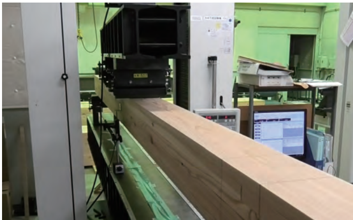
林産物 JAS の製品検査の様子（構造用集成材の曲げ強度の測定）
