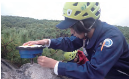
機動観測でGNSS観測機器を取り付けている様子 (アトサヌプリ) ▶ 札幌管区気象台
