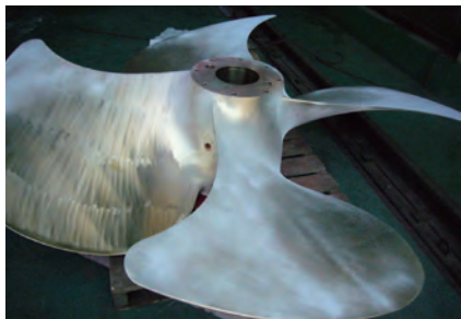
プロペラの羽根の浸透探傷試験 (通称カラーチェック) ▶ 北海道運輸局
