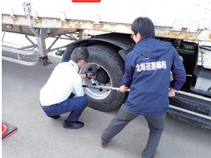
大型車の脱輪啓発活動、トルクレンチを使用して緩んでいたホイールナットの締め付け作業 ▶ 北海道運輸局
