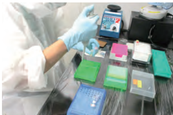
食品表示の検査の様子 (DNA分析による食品の品種判別_反応液の調整) ▶ 農林水産消費安全技術センター
