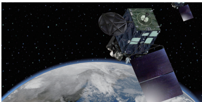
赤道上空約35,800kmで大気の状態を観測 気象衛星ひまわり
