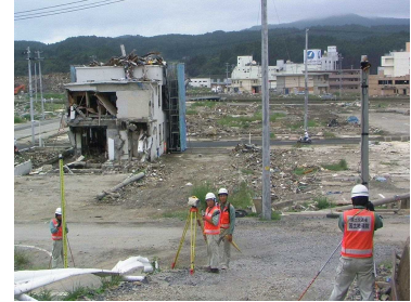
▲ 平成23年東北地方太平洋沖地震での緊急水準測量の様子
