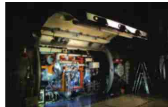
エンジン高空性能 試験装置
