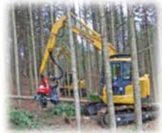
高性能林業機械 (ハーベスタによる伐倒・玉切り作業)
