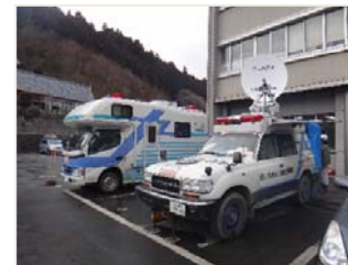
衛星通信車による通信回線の確保
