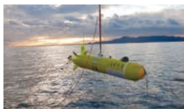
自律型潜水調査機器（AUV）
